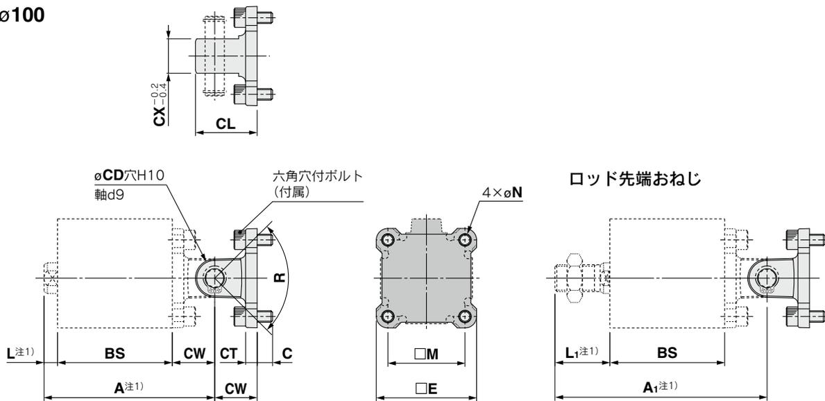
注1) ピストンロッドが引込んだ状態です。単動引込み形(C□Q2□T)の場合、スプリング力によりストローク分、長くなります。
